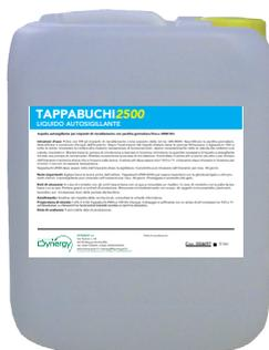
**TAPPABUCHI 2500** sigilla perdite fino a 2.500 litri/giorno. Il principio di funzionamento del prodotto è una sigillazione meccanica dall'esterno che funziona solo in presenza di ossigeno ed è adatto per tutti i materiali in uso (sintetici e metallici). Il prodotto può essere anche utilizzato su impianti a vaso d'espansione aperto.
