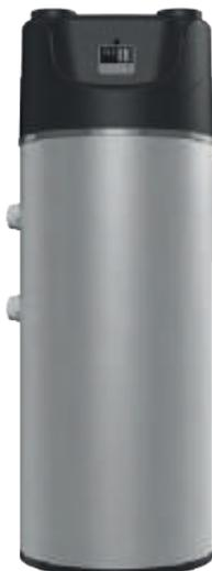
**HERA COMPACT** è una **pompa di calore** per la **produzione di acqua calda sanitaria**, costituita da un **serbatoio in acciaio** con vetrificazione a doppio strato con capacità nominale di accumulo di **270 litri**, con isolamento in poliuretano espanso ad alto spessore rivestito esternamente con ABS grigio.
