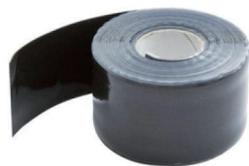
È un nastro autosigillante a base siliconica per riparazioni sugli impianti di riscaldamento, sanitari, e canali d'aria. Resiste a temperature da -70°C fino a +270°C ed è completamente privo di solventi.
