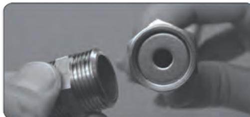
Tenere fermo il dado con una pinza o fissarlo leggermente in una morsa. Inserire la rondella nel dado del raccordo
