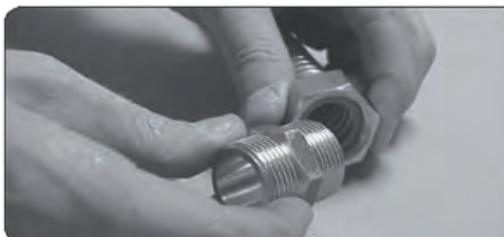
Avvitare il collegamento a vite con la misura giusta nel dado per raccordi (es. collegamento a vite esterno per anello di fissaggio)
