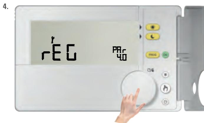
Premere la manopola oppure il tasto
