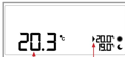
Questo il valore della temperatura ambiente rilevata dal sensore interno / sonda remota.
