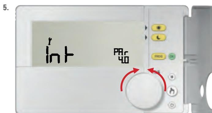
Il display visualizza il dato impostato per quel parametro. Ruotare la manopola in senso orario o antiorario per modificare il dato visualizzato. **Ogni modifica viene memorizzata automaticamente.**
