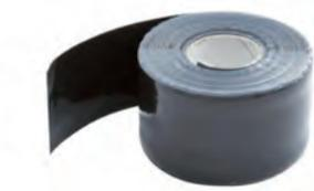
È un nastro autosigillante a base siliconica per riparazioni sugli impianti di riscaldamento, sanitari, e canali d'aria. Resiste a temperature da -70°C fino a +270°C ed è completamente privo di solventi.
